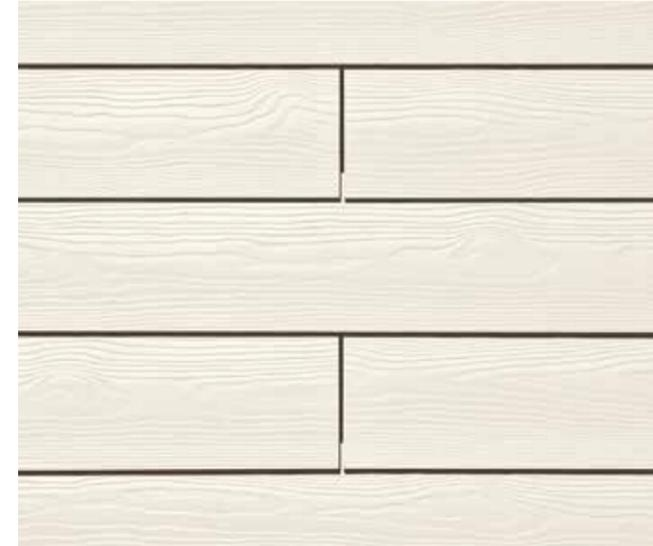
Bei der Verlegung der Fassadenpaneel Cedral Lap als Stülpchalung erfolgt die Verlegung horizontal auf einer vertikal befestigten Traglattung. Die einzelnen vollkantigen Paneel werden übereinander befestigt, wobei das nächste Paneel immer das vorherige um ca. 30 mm überdeckt. Zur Befestigung der Paneel ist die selbstbohrende Cedral Lap Schraube  $4,0 \times 45 \text{ mm}$  (Torx 20) zu verwenden.
