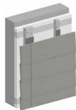
Standardkonstruktion mit vertikaler Traglattung und Dämmstoff zwischen der horizontal angeordneten Konterlattung. Eine zusätzliche Befestigung der Dämmung auf dem Untergrund kann durch Verklebung oder mit Dämmstoffhaltern erfolgen.
