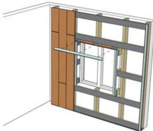
Montieren Sie ein Tragprofil über dem Fenster.
