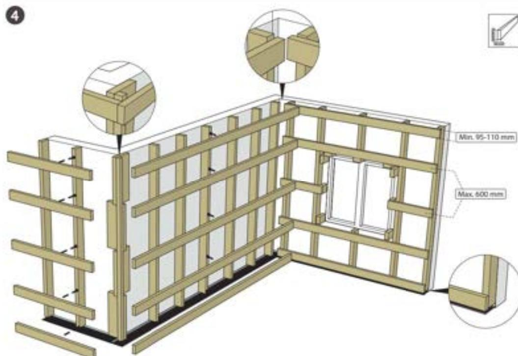
Montieren Sie die horizontale Lattung auf der Holzunterkonstruktion mit ausreichenden Befestigungsmitteln gemäß den Normen und Richtlinien für die Anwendung oder der statischen Berechnung.
