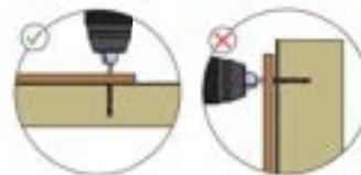
Wo das Profilschalungspaneel an einer vertikalen Latte anliegt, müssen Löcher gebohrt werden. Das mittlere Loch in jedem Profilschalungspaneel als Festpunkt mit 5 mm Durchmesser ausführen. Die anderen Bohrlöcher als Gleitpunkte mit 8 mm Durchmesser ausführen.
