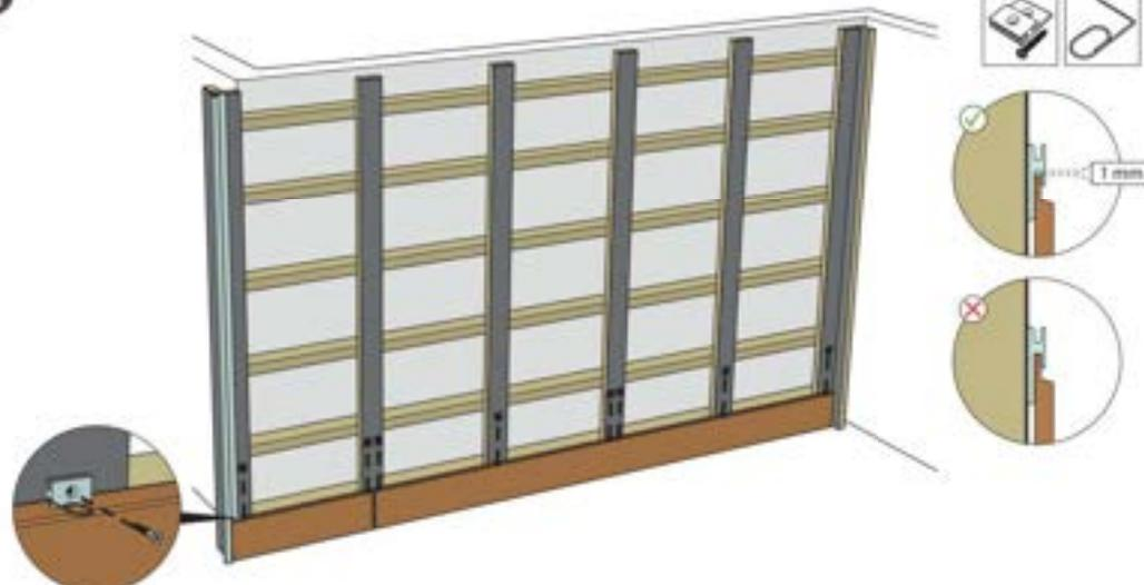
Montieren Sie mit Hilfe der Montagehilfe die zweite Reihe Universalclips so, dass jeder Montagekopf nach oben zeigt. Dabei bitte auf Folgendes achten:
