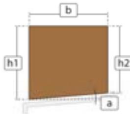
Messen Sie die Neigung der Fensterbank und schneiden Sie das erste Profilschalungspaneel zu.
