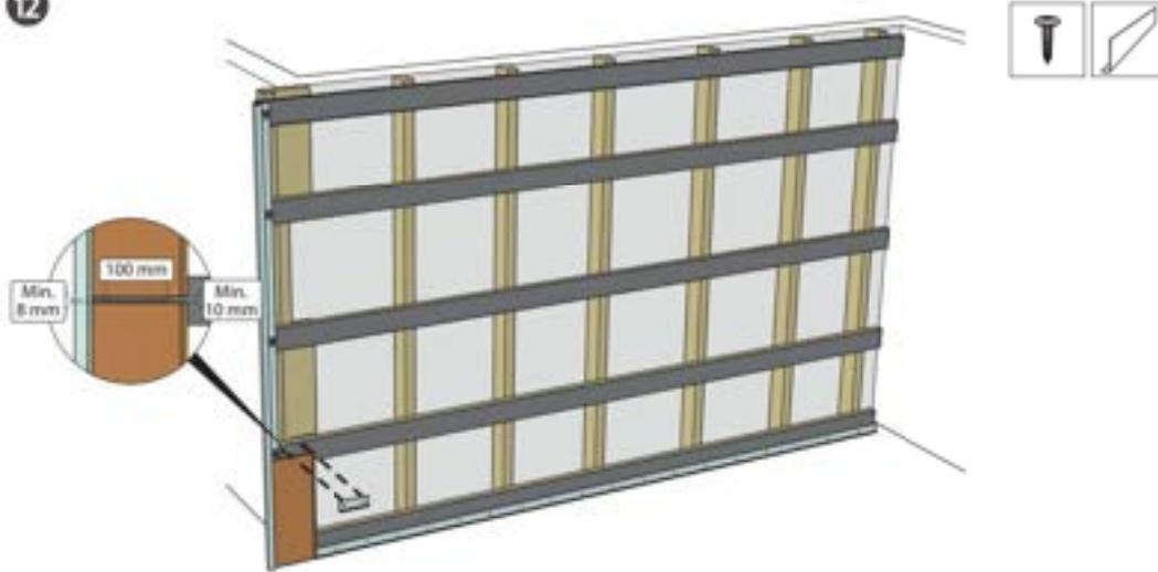
Schneiden sie das Tragprofil auf 100 mm zu. Montieren Sie das Tragprofil 8 mm über dem untersten Profilschalungspaneel auf der horizontalen Latte (die horizontale Fuge ist insgesamt 10 mm).
