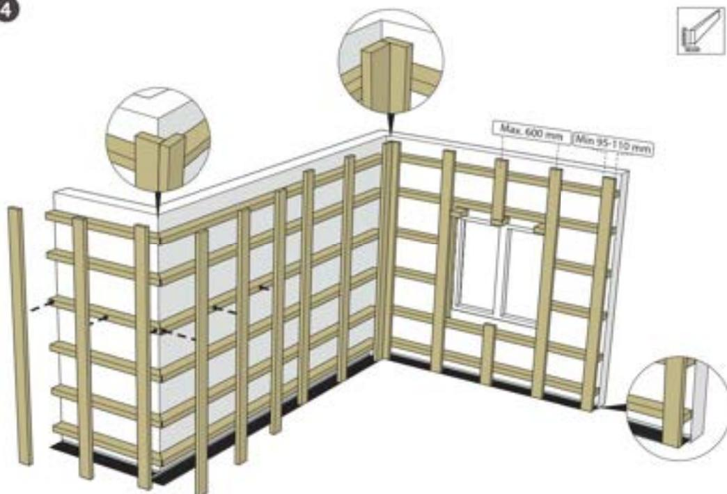
Montieren Sie die vertikale Lattung auf der Holzunterkonstruktion mit ausreichenden Befestigungsmitteln gemäß den Normen und Richtlinien für die Anwendung oder der statischen Berechnung.
