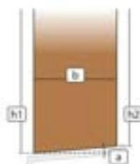
Messen Sie die Neigung der Fensterbank und schneiden Sie das erste Profilschalungspaneel zu.
