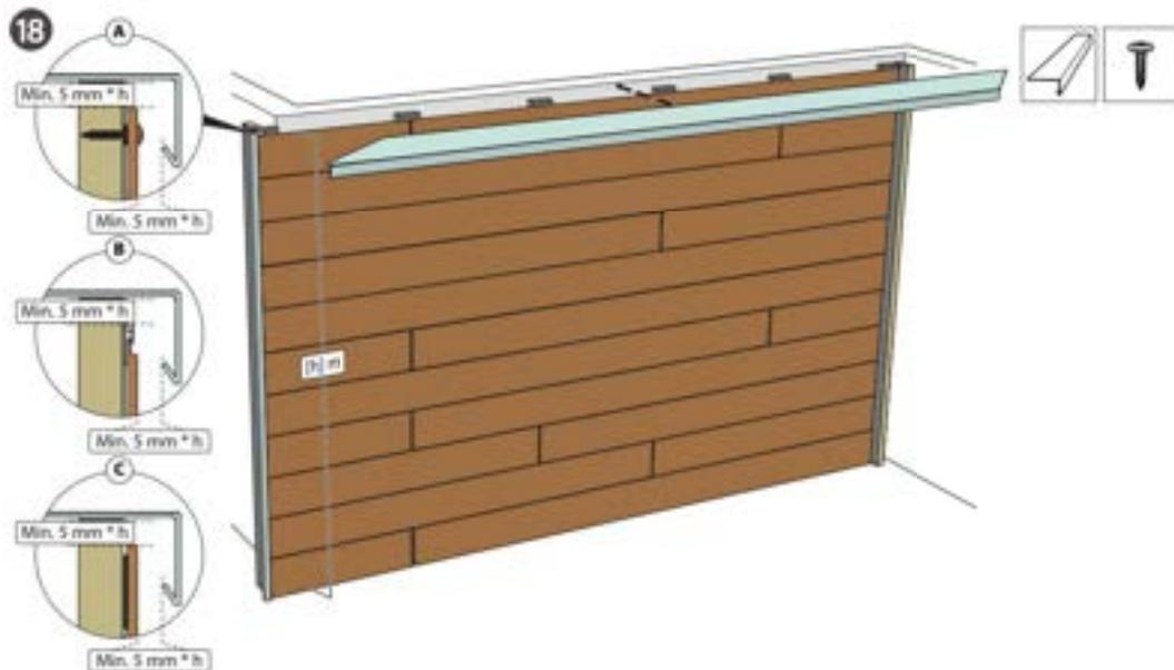
Schließen Sie die Fassade ab zum Beispiel mit einem Dachrandprofil.
