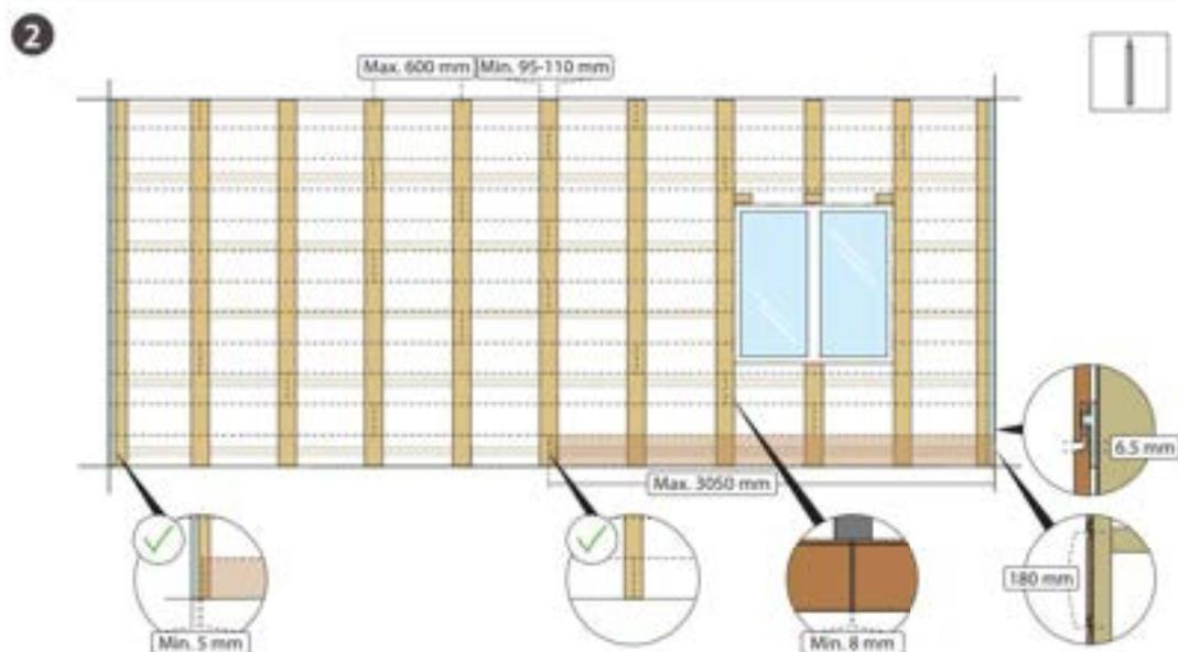
Fertigen Sie auf der Grundlage der Abmessungen in Kapitel 5.1 eine technische Zeichnung an. Zeichnen Sie die vertikale Lattung, Profilschalungspaneele, Zwischenfugen, Eck- und Endprofile.
