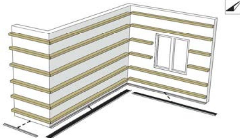
Stellen Sie sicher, dass die horizontale Lattung installiert ist. Montieren Sie dann die Lüftungsgitter an der Unterseite und bei einer Unterbrechung der Fassade. Die Lüftungsgitter sollen mit einem freien Luftdurchlass von mindestens  $200 \text{ cm}^2$  pro  $\text{m}^2$  montiert werden.
