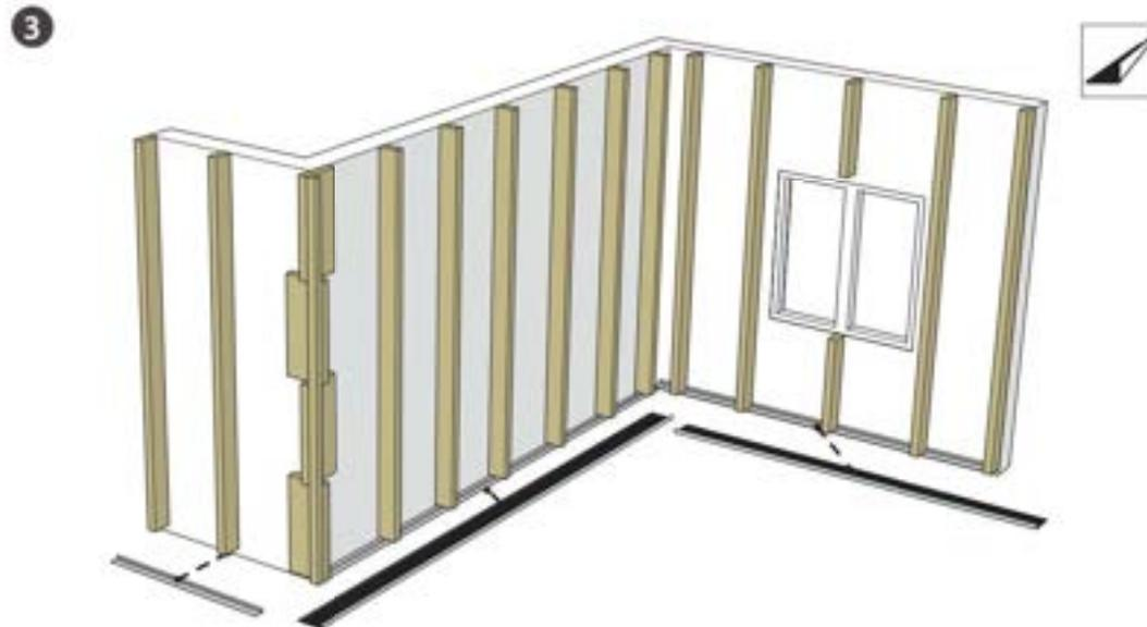
Stellen Sie sicher, dass die vertikale Lattung installiert ist. Montieren Sie dann die Lüftungsgitter an der Unterseite und bei einer Unterbrechung der Fassade. Die Lüftungsgitter sollen mit einem freien Luftdurchlass von mindestens  $200 \text{ cm}^2$  pro  $\text{m}^2$  montiert werden.
