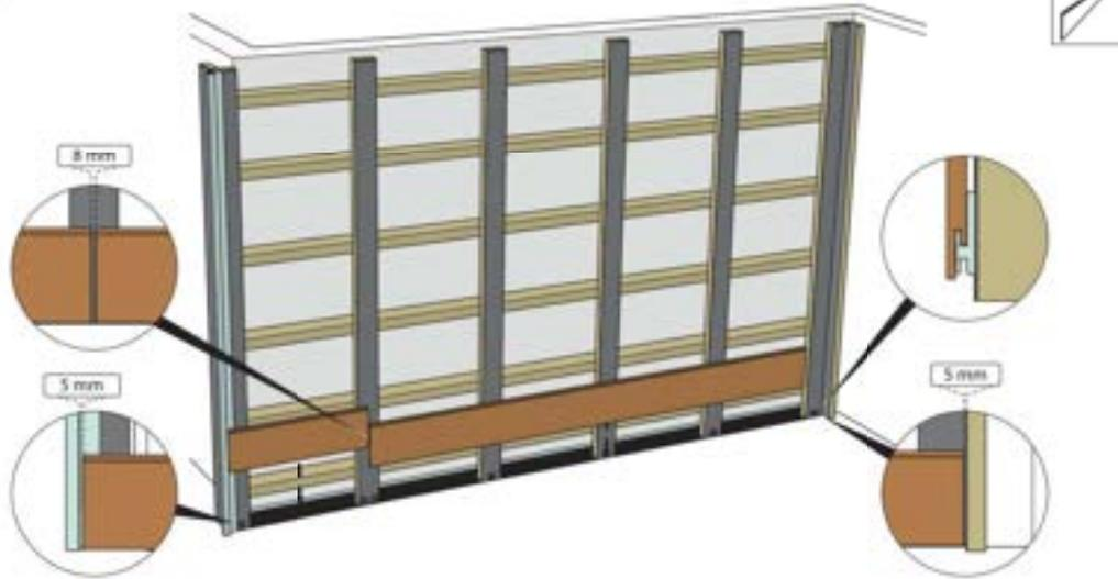
Setzen Sie die erste Reihe Profilschalungspaneele von oben in die Universalclips ein.
