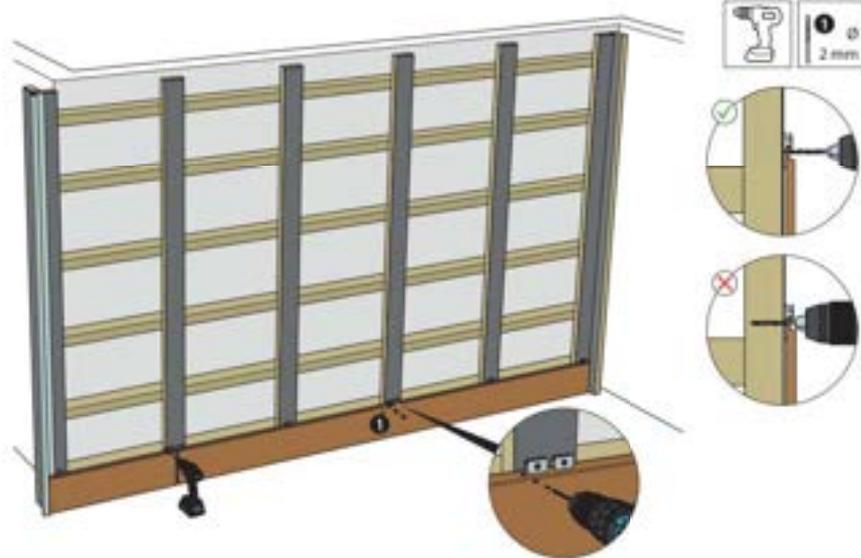
Jedes Profilschalungspaneel wird an einem Punkt mittels Nagel fixiert. Bohren Sie ein Loch mit 2 mm Durchmesser nur durch den dünnen Teil des Profilschalungspaneels hinter dem sich eine vertikale Latte befindet. Achten Sie darauf, dass dieser Punkt möglichst nahe der Mitte des Profilschalungspaneels liegt, aber nicht zwischen zwei Clips.
