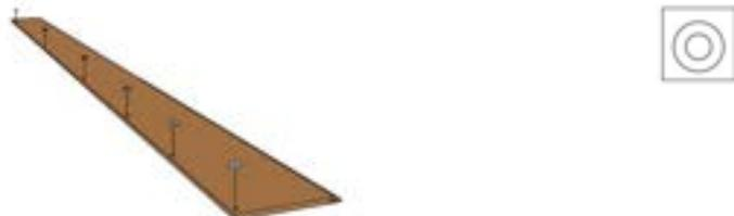
Kleben Sie Montageringe mit der klebenden Seite mittig auf alle Löcher auf der Rückseite der Fassadenplatte.
