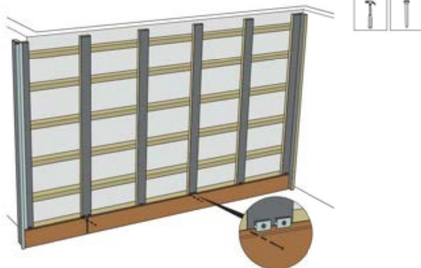
Fixieren Sie das Profilschalungspaneel mit einem Senkkopfnagel im 2-mm-Bohrloch an der vertikalen Latte.
