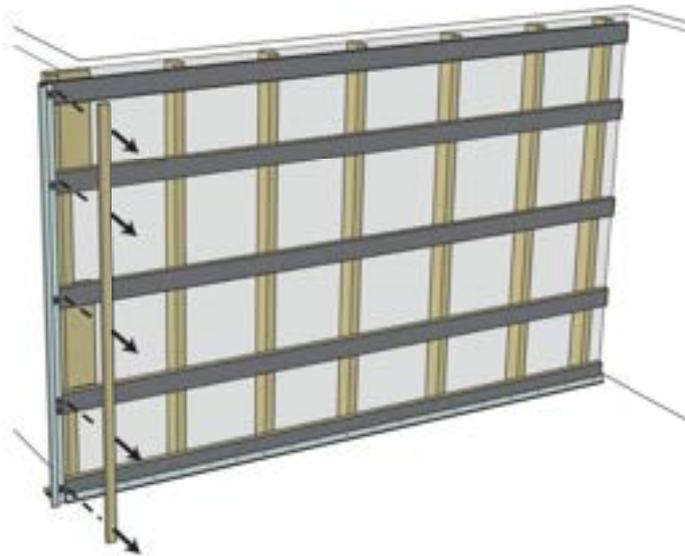
Demontieren Sie Montageleiste bzw. Wasserwaage bzw. schalten Sie den den Baulaser aus.
