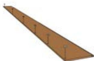
Kleben Sie Montageringe mit der klebenden Seite mittig auf alle Löcher auf der Rückseite der Fassadenplatte.
