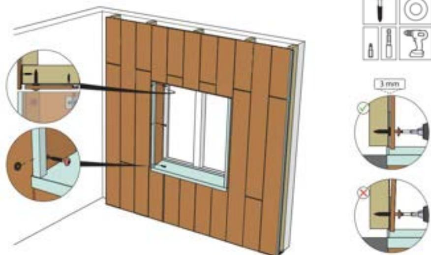
Schrauben Sie das Profilschalungspaneel und die Montageringe mit HPL-Schnellmontageschrauben fest. Achten Sie darauf, dass die Schrauben mittig durch die Bohrlöcher gehen.
