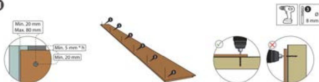
Wo das Profilschalungspaneel an den horizontalen Traglatten anliegt, müssen Löcher gebohrt werden. Alle Löcher als Gleitpunkte mit 8 mm Durchmesser ausführen.
