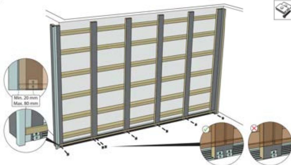
Montieren Sie die erste Reihe der Universalclips unter der Wasserwaage, Montageleiste oder Laserlinie mit dem Montagekopf nach unten. Dabei bitte auf Folgendes achten:
