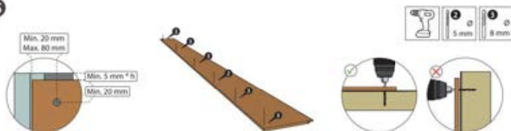
Wo das Profilschalungspaneel an einer vertikalen Latte anliegt, müssen Löcher gebohrt werden. Das mittlere Loch in jedem Profilschalungspaneel als Festpunkt mit 5 mm Durchmesser ausführen. Die anderen Bohrlöcher als Gleitpunkte mit 8 mm Durchmesser ausführen.
