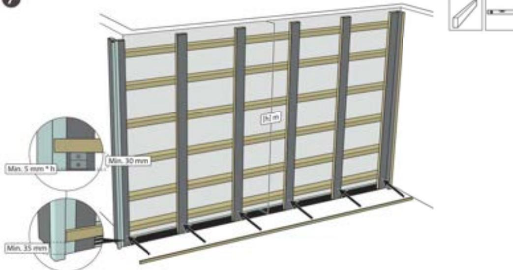
Montieren Sie eine Wasserwaage oder Montageleiste mit Schraubzwingen in mindestens 35 mm Höhe an den vertikalen Lattung. Sie können auch mit einem Baulaser eine Linie projizieren.
