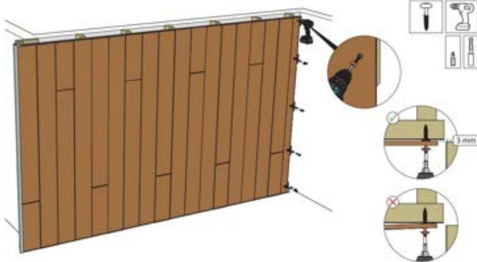
Schrauben Sie das Profilschalungspaneel und die Montageringe mit HPL-Schnellmontageschrauben fest. Achten Sie darauf, dass die Schrauben mittig durch die Bohrlöcher gehen.
