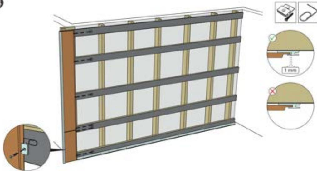
Montieren Sie mit Hilfe der Montagehilfe die zweite Reihe Universalclips so, dass der Montagekopf nach rechts zeigt. Dabei bitte auf Folgendes achten:
