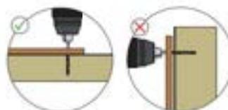
Wo das Profilschalungspaneel an den horizontalen Latten anliegt, müssen Löcher gebohrt werden. Das mittlere Loch in jedem Profilschalungspaneel als Festpunkt mit 5 mm Durchmesser ausführen. Die anderen Löcher als Gleitpunkte mit 8 mm Durchmesser ausführen.
