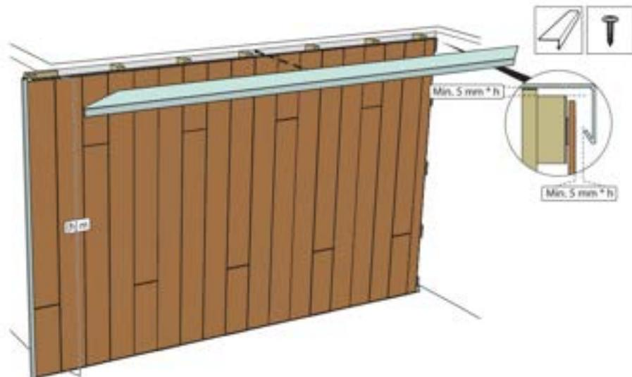
Schließen Sie die Fassade ab zum Beispiel mit einem Dachrandprofil.
