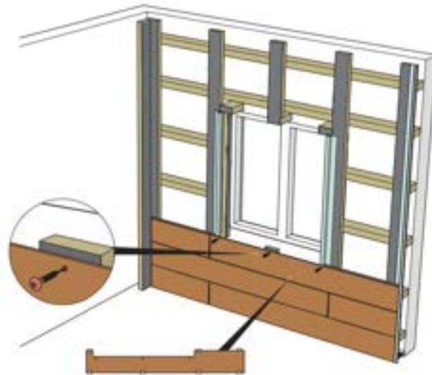
Schrauben Sie das Profilschalungspaneel und die Montageringe mit HPL-Schnellmontageschrauben fest. Achten Sie darauf, dass die Schrauben mittig durch die Bohrlöcher gehen.
