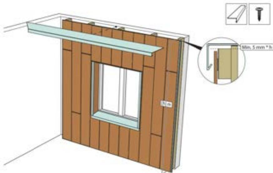
Schließen Sie die Fassade ab zum Beispiel mit einem Dachrandprofil.
