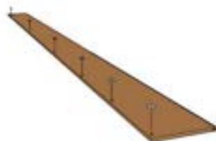
Kleben Sie Montageringe mit der klebenden Seite mittig auf alle Löcher auf der Rückseite der Fassadenplatte.
