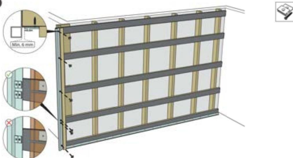
Montieren Sie die erste Reihe Universalclips neben der Wasserwaage, Montageleiste oder Laserlinie mit dem Montagekopf nach links. Dabei bitte auf Folgendes achten:
