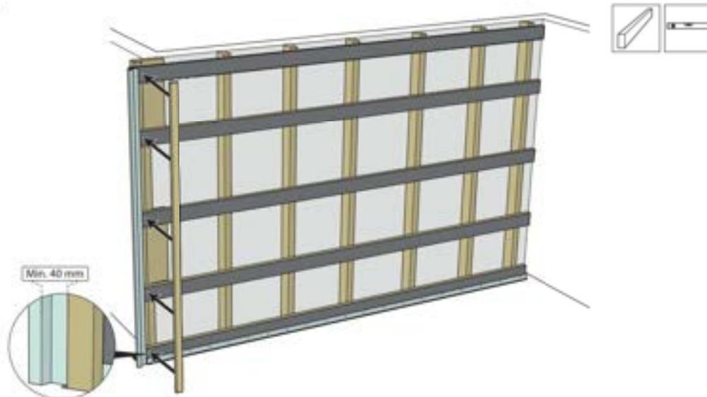
Montieren Sie eine vertikale Montageleiste oder Wasserwaage mit Schraubzwingen in mindestens 40 mm Abstand von der Innenseite der Eckprofile auf den horizontalen Latten. Sie können auch mit einem Baulaser eine Linie projizieren.
