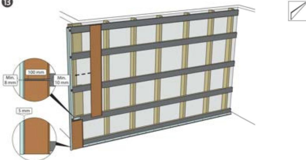
Setzen Sie das zweite Profilschalungspaneel von rechts nach links in die Universalclips.
