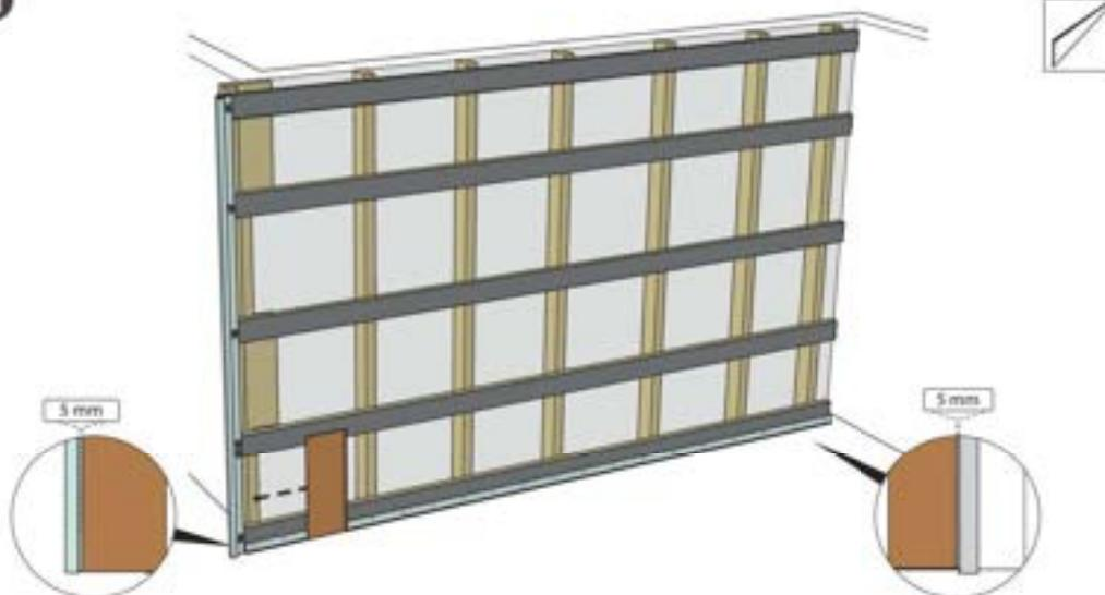
Setzen Sie das erste Profilschalungspaneel von rechts nach links in die Universalclips oder das Anfangsprofil.
