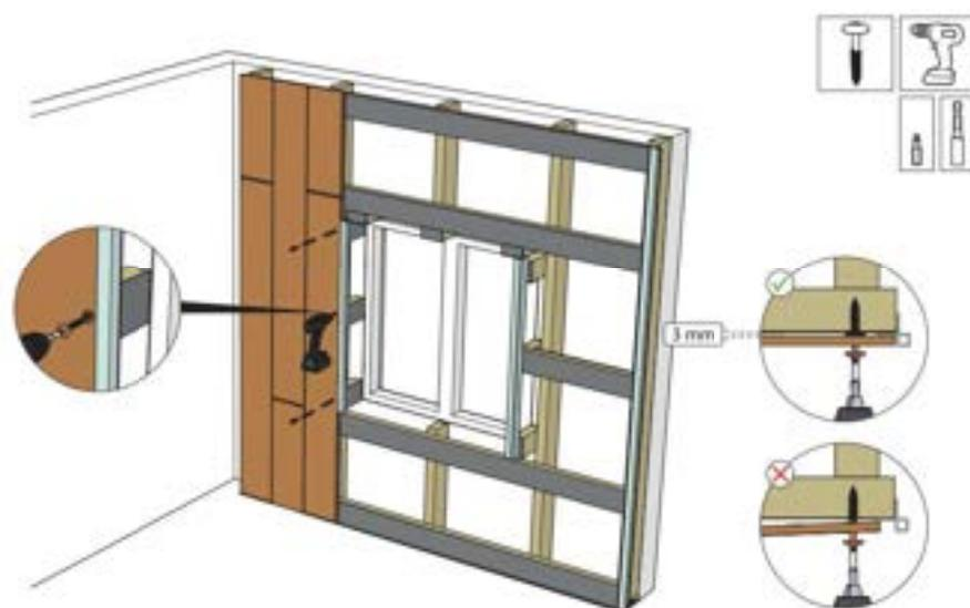
Schrauben Sie das Profilschalungspaneel und die Montageringe mit HPL-Schnellmontageschrauben fest. Achten Sie darauf, dass die Schrauben mittig durch die Bohrlöcher gehen.
