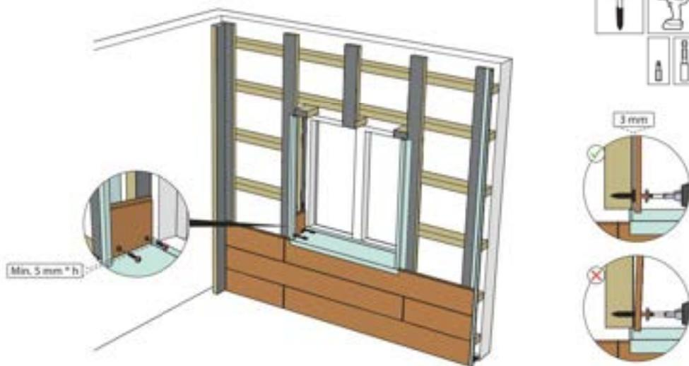
Schrauben Sie das Profilschalungspaneel und die Montageringe mit HPL-Schnellmontageschrauben fest. Achten Sie darauf, dass die Schrauben mittig durch die Bohrlöcher gehen.
