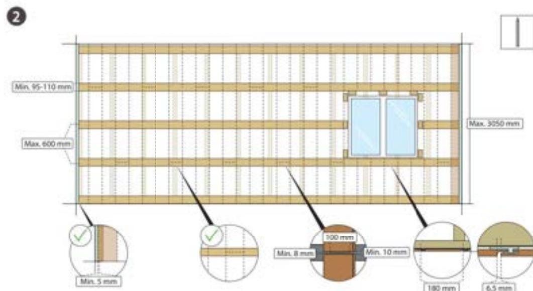
Fertigen Sie auf der Grundlage der Abmessungen in Kapitel 5.1 eine technische Zeichnung an. Zeichnen Sie die horizontalen Traglattung, Profilschalungspaneele, Zwischenfugen, Eck- und Endprofile.
