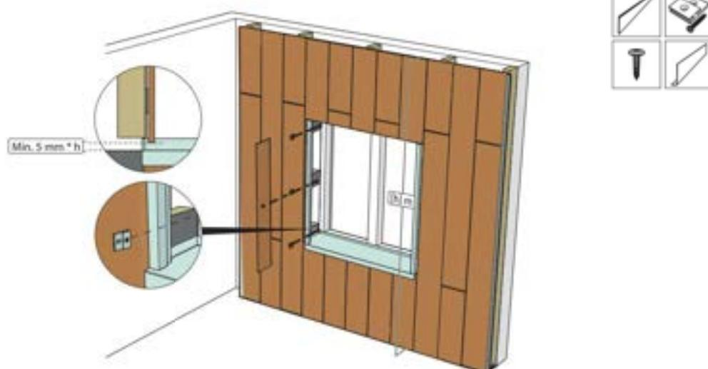
Montieren Sie Universalclips an den Innenseiten des Fensters auf den horizontalen Latten. Setzen Sie das Profilschalungspaneel in die Universalclips ein.
