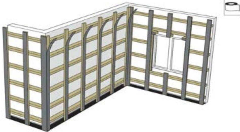
Befestigen Sie das EPDM-Band an der vertikalen Lattung.
