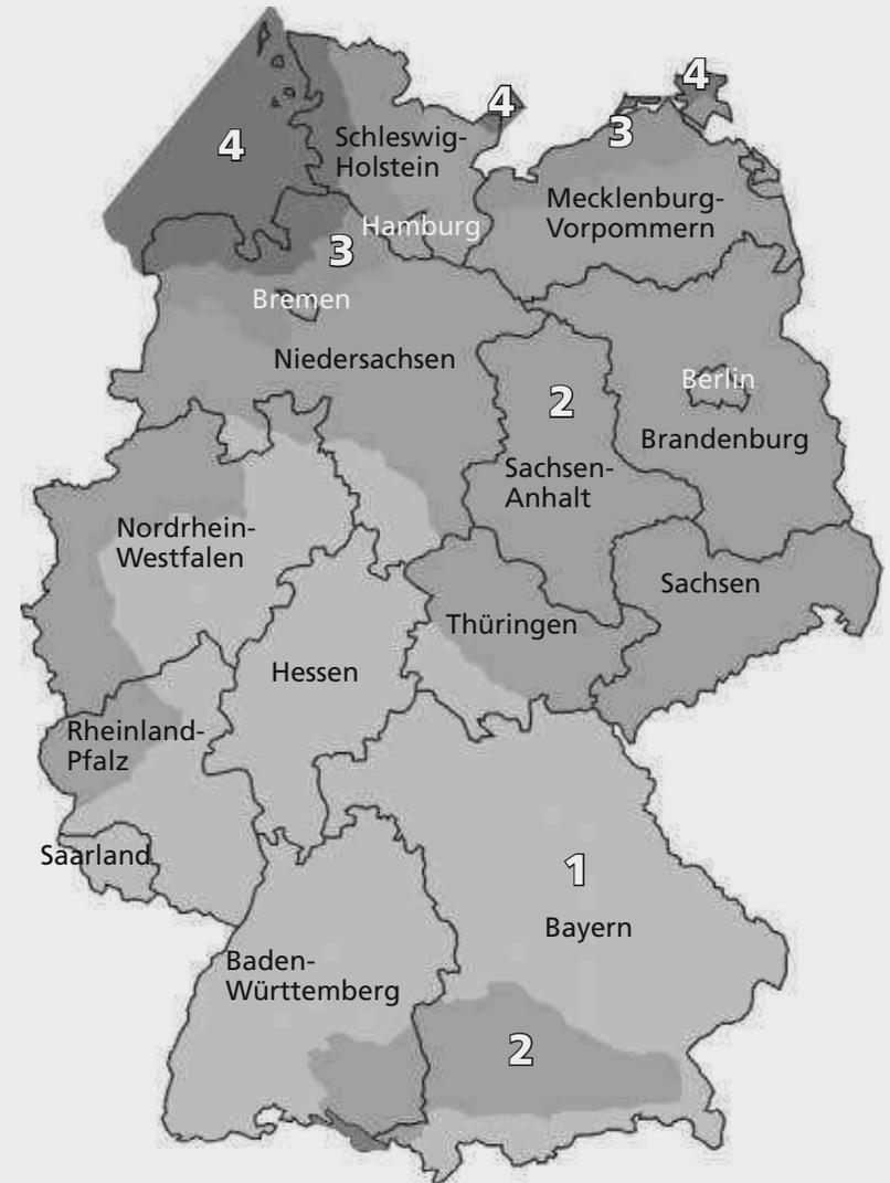
Geschwindigkeitsdruck  $q_p$  (Berechnungswert  $F_d = F_{rep} \cdot \gamma_F$ ) Gebäudehöhe  $h \leq 10$  m
